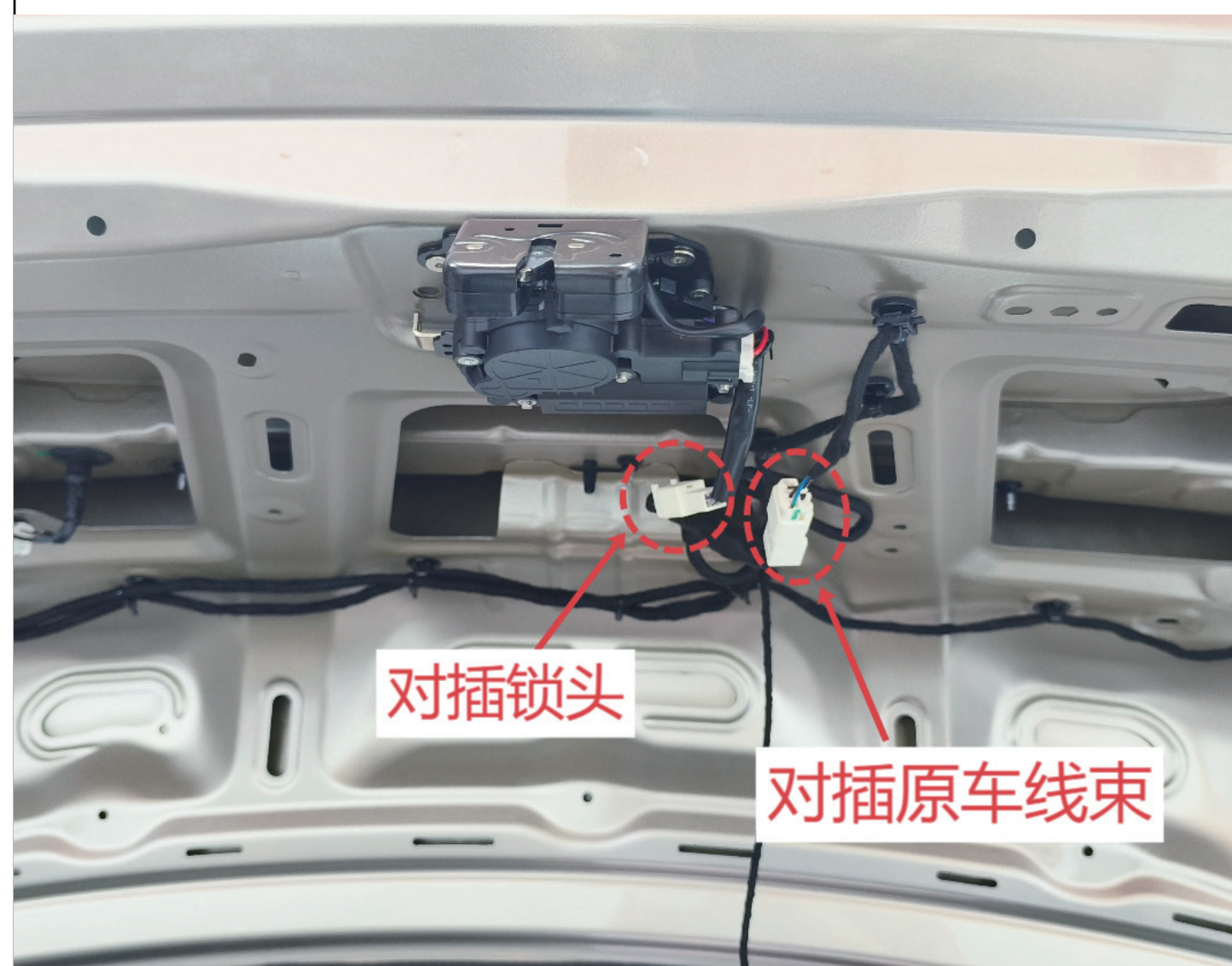
10. 将原车锁机插头与配货转接插头对插（见下图）
